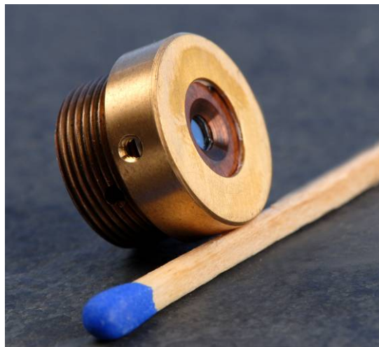
Basis der neuen Lasertechnologie: Halbleiterchip für den 2–3 \mu\text{m} Wellenlängenbereich, in einer speziellen Wärmesenke.
